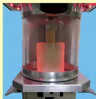
Рис. 5: Как только внутри вакуумной камеры образуется необходимый вакуум, светодиодный индикатор меняет свет с синего на красный.
