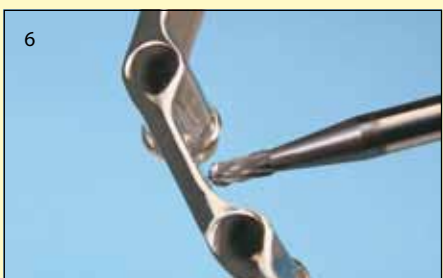
6 вердосплавным кернбором 1,4 на соответствующем месте насверливают углубление.
