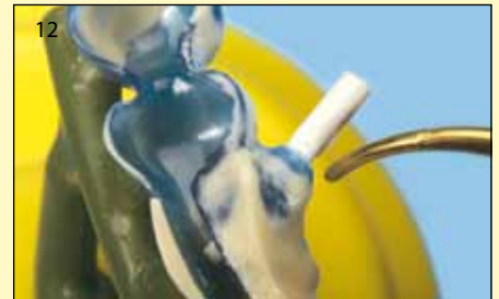
12 Восковую уплотнительную манжету соединяют с восковой моделью каркаса.
