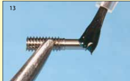
13 После изолирования установочный штифт ввинчивают в резьбовую втулку.
