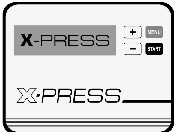
Включите пресс сетевым включателем. При наличии питающего напряжения сети загорится экран панели управления.
